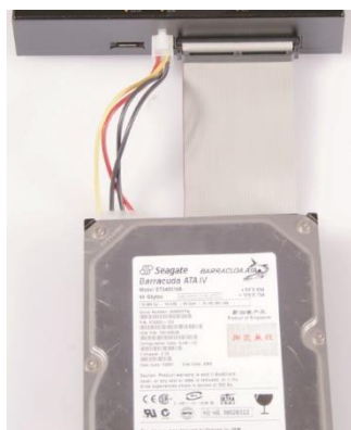
Connect IDE HDD
